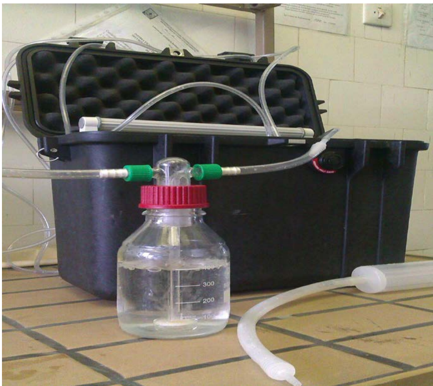
Fig. 3. Măsurarea radonului în apă cu ajutorul Radonometrului RTM 1688-2.
