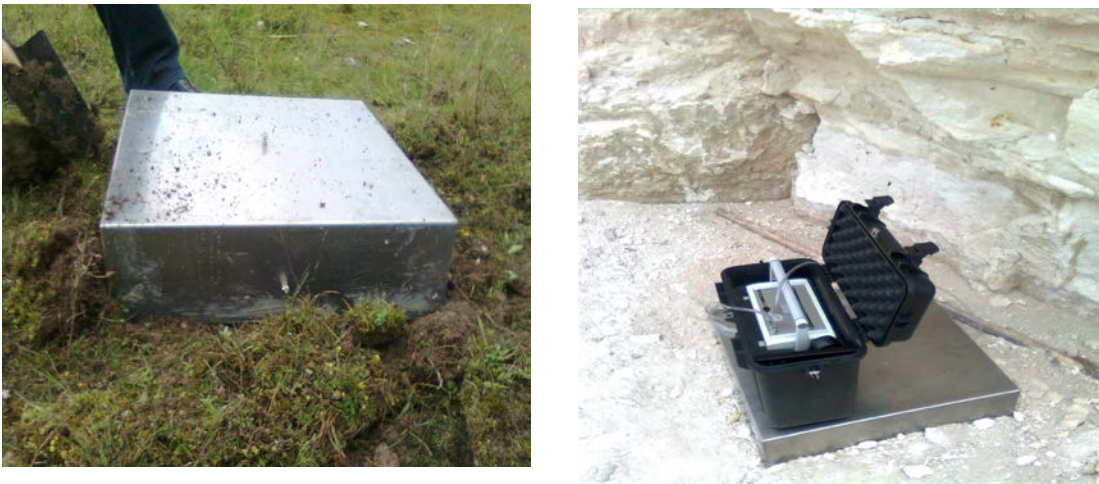
Fig. 2. Efectuarea măsurătorilor concentrațiilor de radon.
